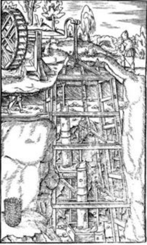
G. Agricola, De Re Metallica kitabından bir su pompası çizimi.
